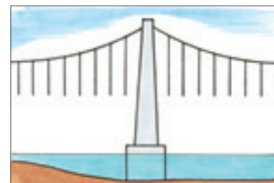
主ケーブルを端から引き出して設置し、ハンガーロープを取り付ける。
