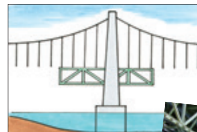
主塔を起点にけたを少しずつ横にのびながらハンガーロープに取り付ける。
