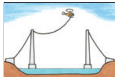
ヘリコプターを使って主塔の上にロープを通し、2つの橋台とつなぐ。
