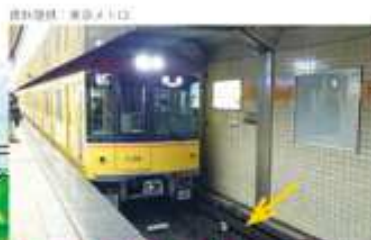
図中緑色の、左側のレールの外側にある「カーブレール (右線軌条)」から電気をとりこむことができます。
