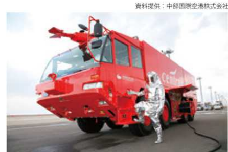
大型化学消防車 航空機や空港設備に火災が起きたときに出動する消防車。大型機が離着陸するような空港には、そなえることが義務づけられています。
